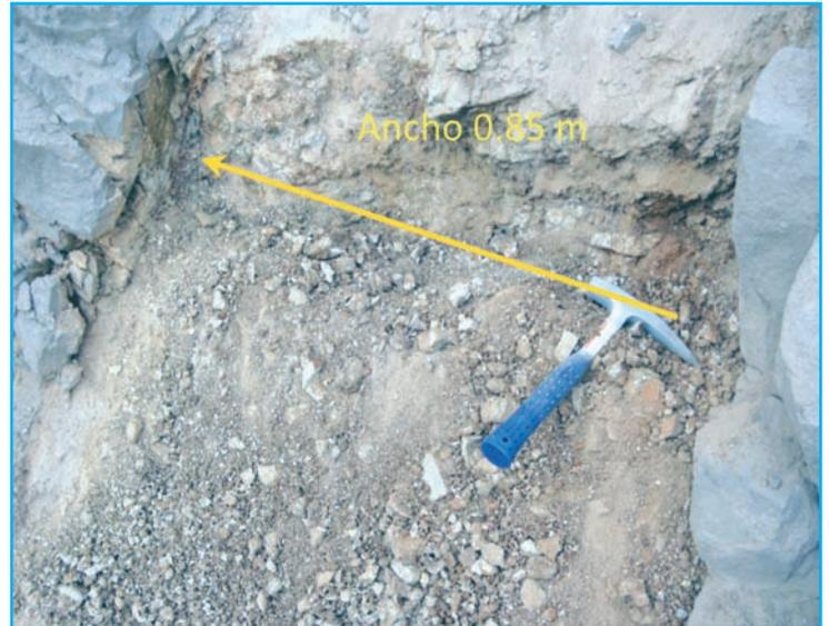
[Foto 2].- Fallas presentes en el trazado del túnel. En total el túnel es atravesado por cuatro fallas de estas características.
